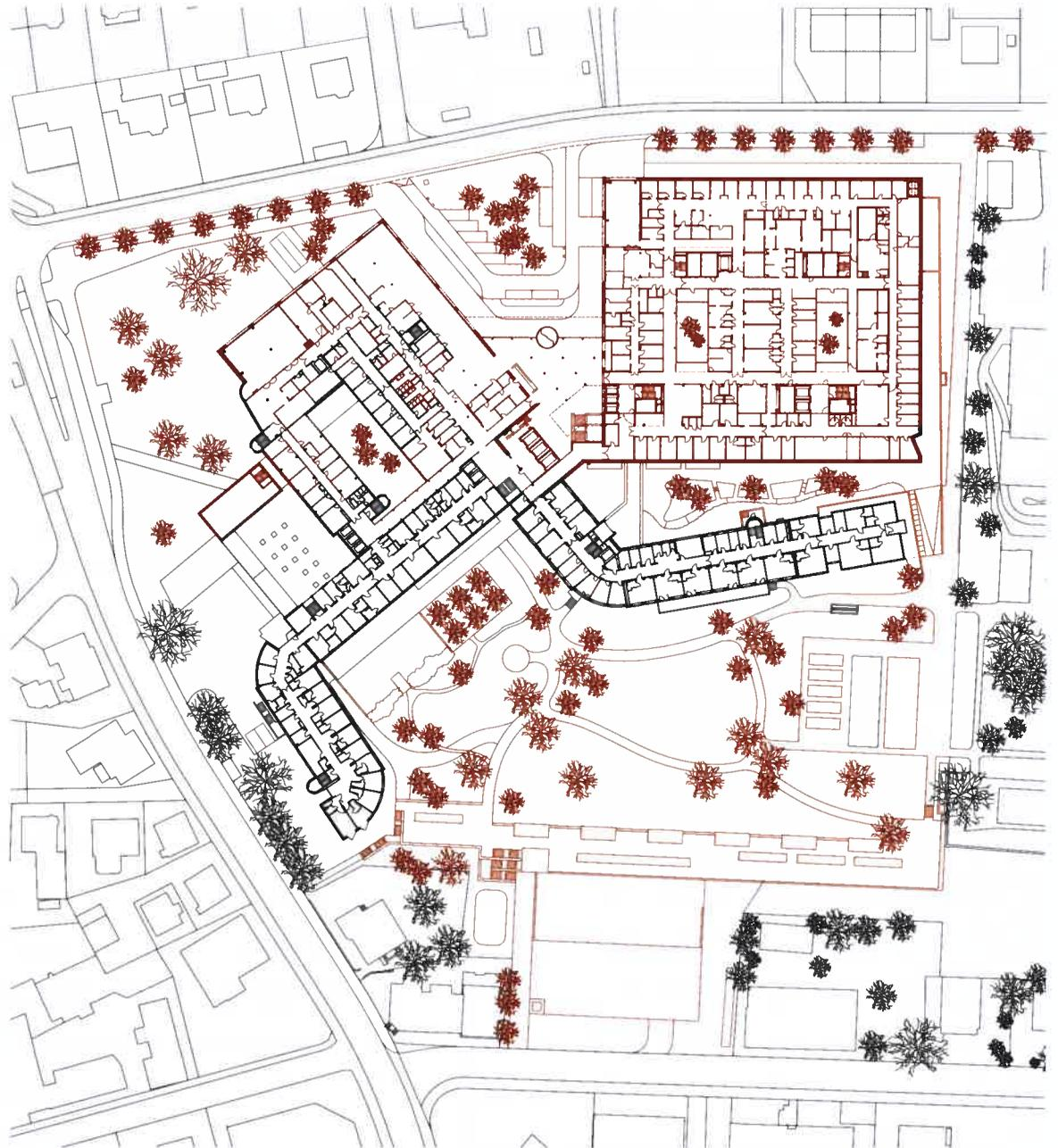
6 Das Erdgeschoss mit den Neu- und Umbauteilen in Rot.
