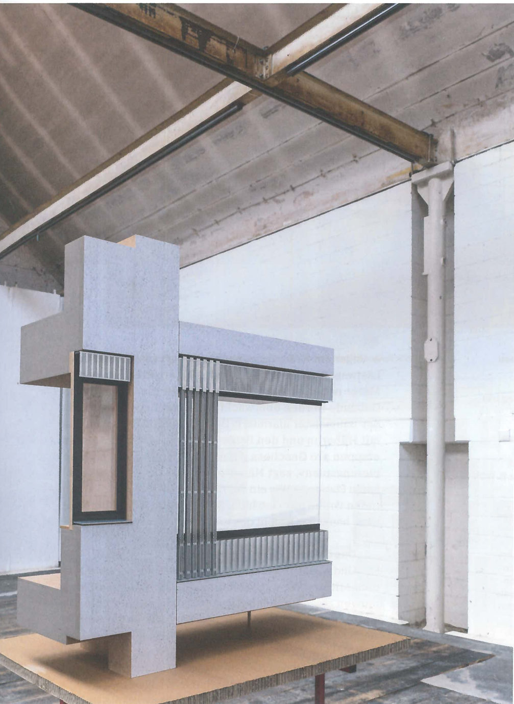
Die für die Erscheinung wichtigen Details werden akribisch geplant – hier die sogenannten «Broschenfenster» des Restaurants als grosses Modell.
