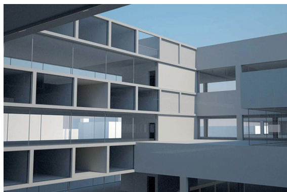
Abb. 33 Mira Al-Kassar, Patrick Ayer, Marlène Oberli: kreuzweise gestapelte Tragstruktur in Zürich-Hardbrücke, LABEX 2008
