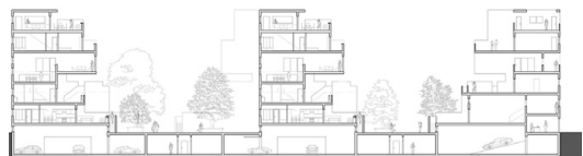
Abb. 30 Querschnitt mit Tragscheiben
