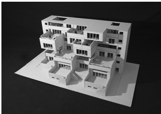
Abb. 32 Gestaffelte «plateaux» mit querlaufenden Tragscheiben
