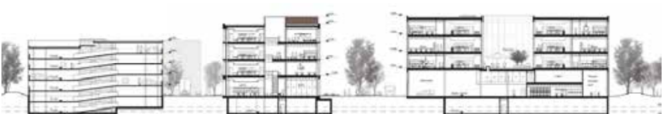
Querschnitt Parkhaus, Büro-/Laborgebäude Empa und ETH Gebäude
