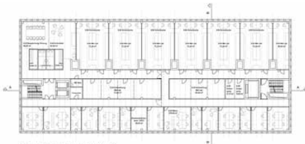
Grundriss Empa Labor- und Bürogebäude, Regelgeschoss
